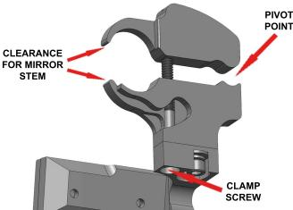
4 - BEFORE FULLY TIGHTENING THE CLAMP SCREW,
